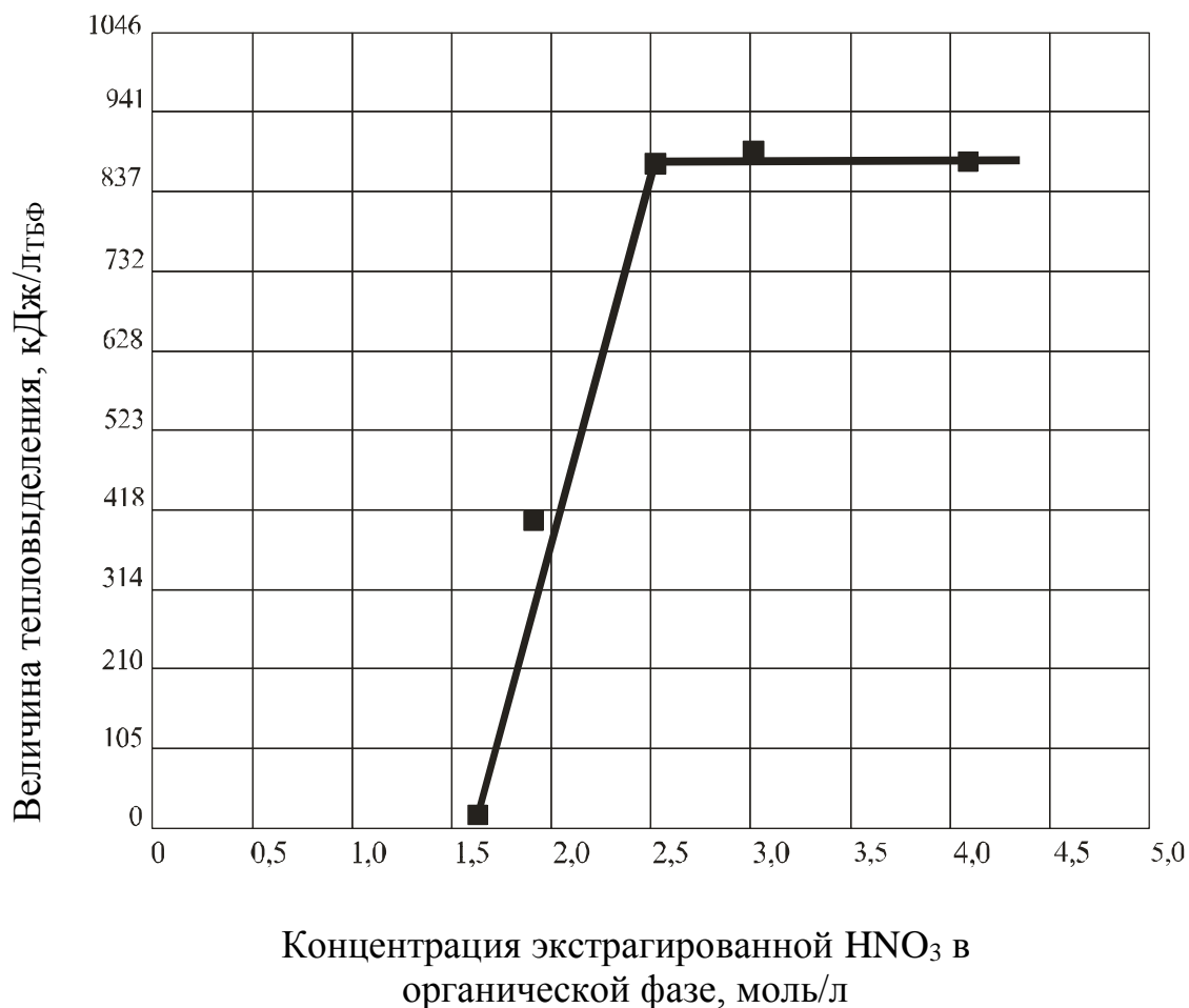
Рис. 13. Зависимость величины тепловыделения от концентрации экстрагированной HNO 3 при окислении ТБФ в закрытом сосуде
